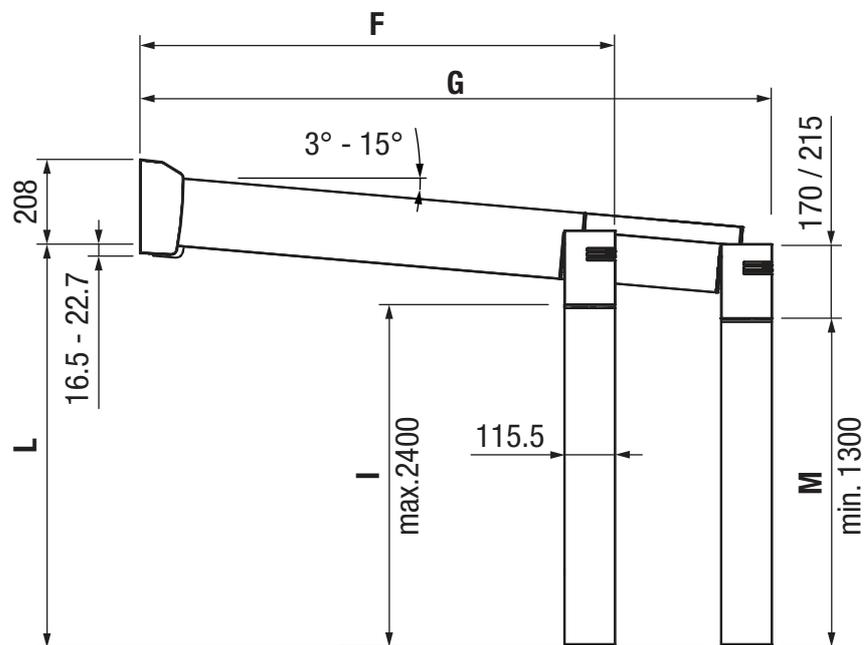
F / G = Ausladung horizontal (min. 1000 mm / max. gemäss Dachlast)
