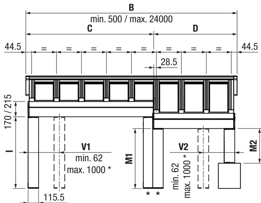
B = Totalbreite (Wandanschlussprofil mit den beiden Seitendeckeln)
