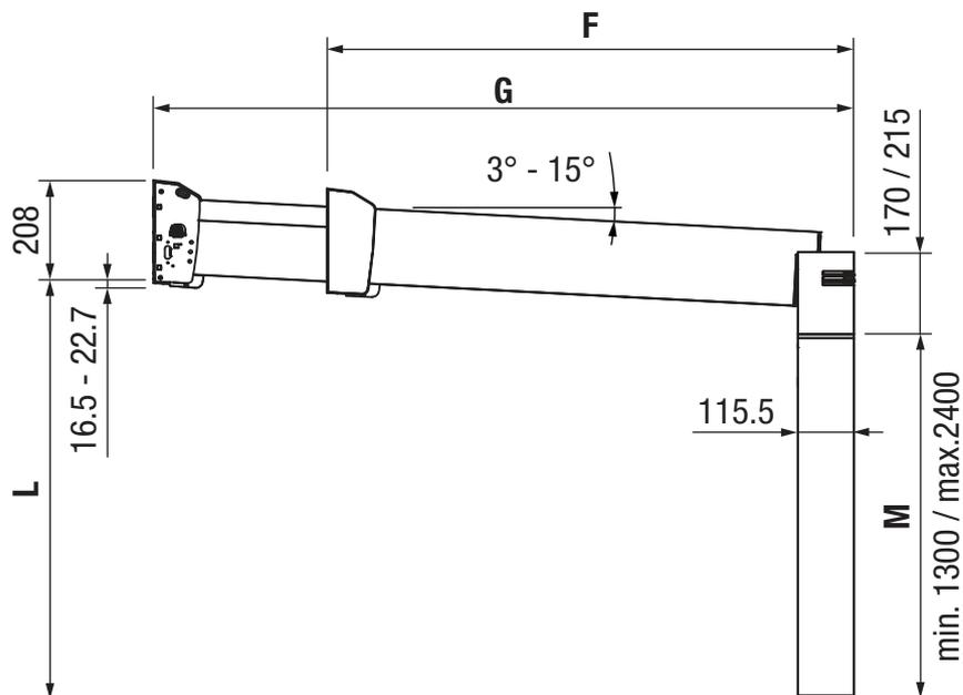
F / G = Ausladung horizontal (min. 1000 mm / max. gemäss Dachlast)
