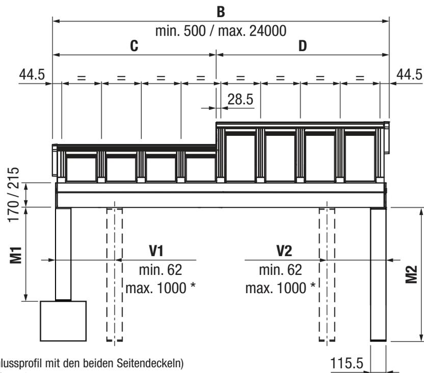
B = Totalbreite (Wandanschlussprofil mit den beiden Seitendeckeln)
