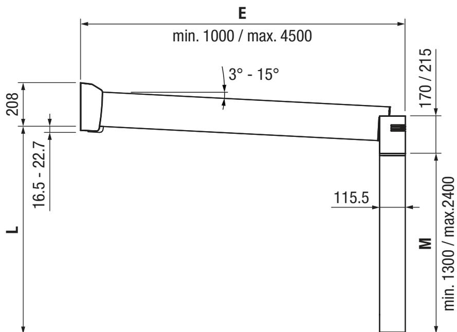
**E** = Ausladung horizontal (min. 1000 mm / max. gemäss Dachlast)
