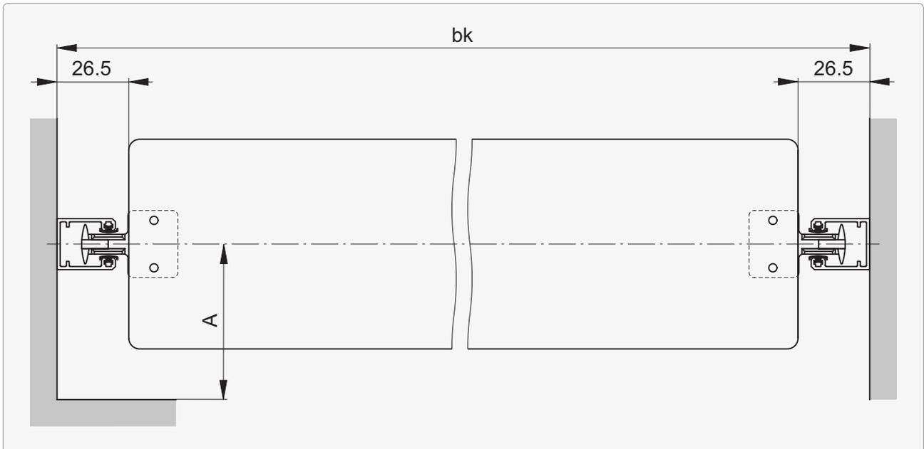
Horizontalschnitt: Führungsschiene Fix-L
