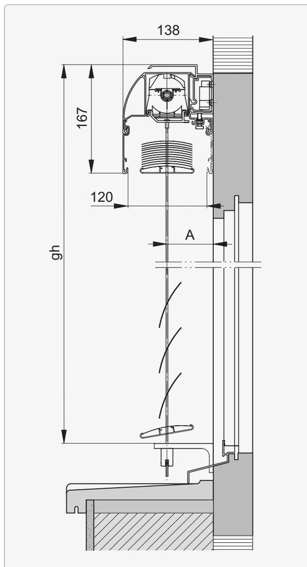
Horizontalschnitt: Führungsschiene konventionell
