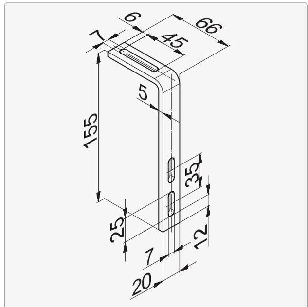
**Befestigungsviereck unten zu Mittelstütze**
