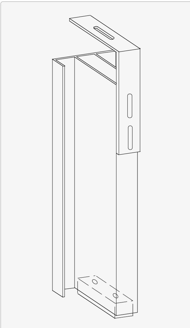
**Befestigungswinkel oben zu Mittelstütze**
