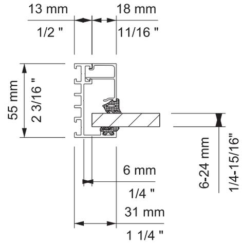
Bezeichnung: Horizontalschnitt, Wandanschluss mit SF20 Senkrechttrahmen
