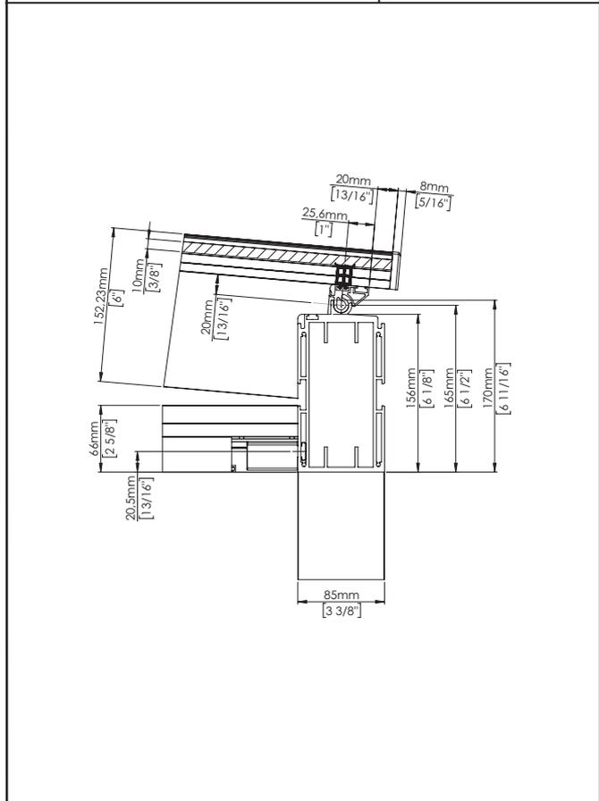
Bezeichnung: Vertikalschnitt, Anschluss Querfette mit Querträger
