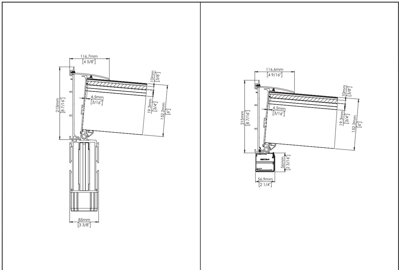
Bezeichnung: Vertikalschnitt, Bereich Wandanschluss mit Querfette und Stützen untergestellt
