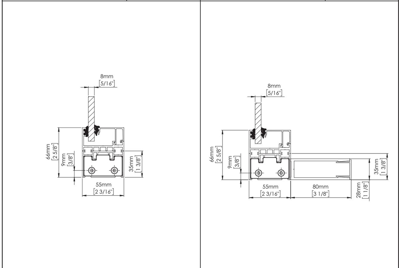
Bezeichnung: Vertikalschnitt, Querträger, Festelement oben
